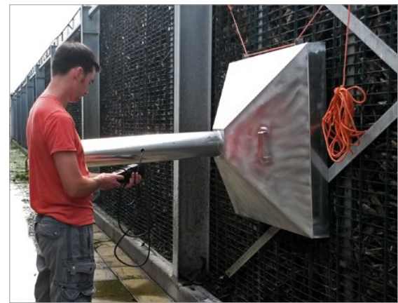
Messung der Ammoniakkonzentration am Biofilter (2. Stufe) einer 2-stufigen Abluftreinigungsanlage
